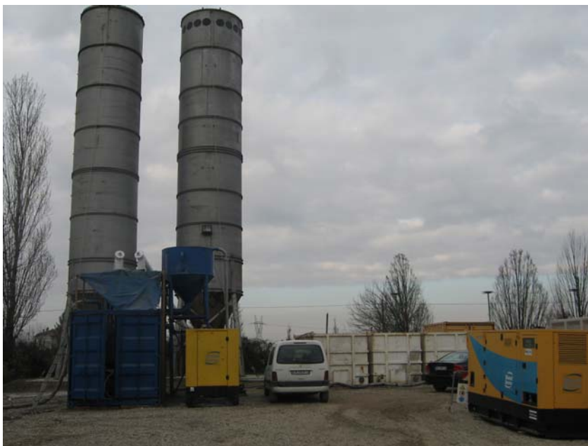
IMPIANTO DI PRODUZIONE DEL FANGO AUTOINDURENTE
