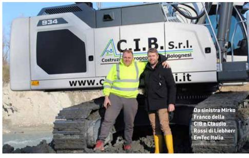
L'R 934 ha un peso operativo rispettivamente di 35 tonnellate, raggiunge una potenza di 200 kW/272 CV grazie ad un motore Liebherr D944 A7-25, da 4 cilindri in linea, 4 tempi diesel, Common Rail turbo intercooler, da 1415 Nm a 1350 girim/min, con post trattamento dei gas di scarico DOC e SCR.
